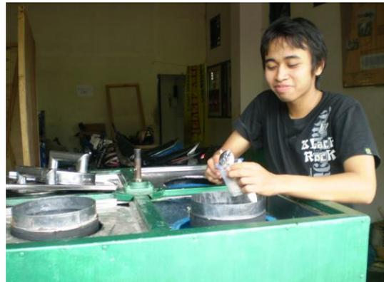
**Gambar 2. Uji Coba Pembuatan Es Krim dengan Mesin Pemutar**
