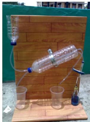
**Gambar 1.** Alat Destilasi Sederhana
