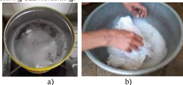
Gambar 8. Proses preparasi kain: a) Scouring kain katun dan b) Proses Mordanting sebelum aplikasi
