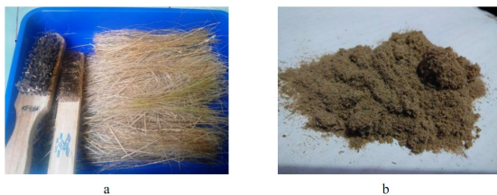
Gambar 1. Serat sebelum preparasi (a), serat setelah preparasi (b)
