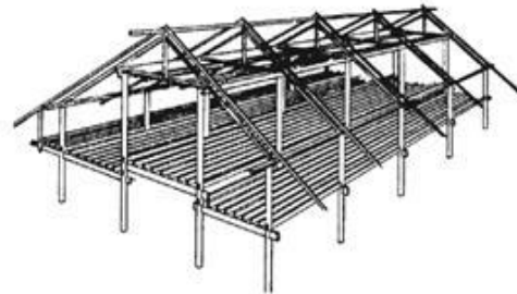
Gambar 1. Kerangka Bagunan Rumah Tradisional Aceh
