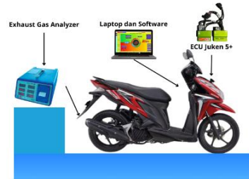
Gambar 6. Skema pemasangan gas analyzer
