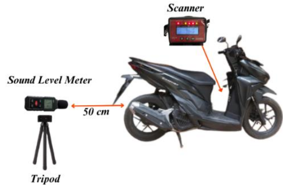
Gambar 4. Skema pemasangan Gas Analyzer dan Sound Level Meter
