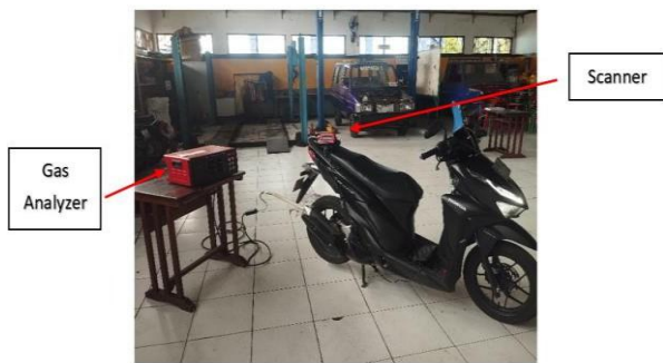
Gambar 4. Skema pemasangan Gas Analyzer
