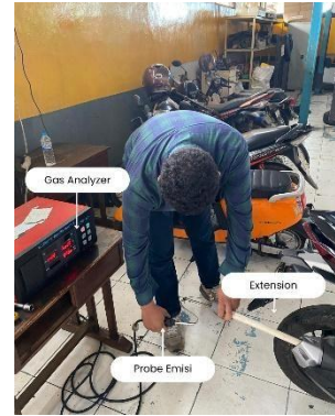
Gambar 4. Skema pemasangan Gas Analyzer
