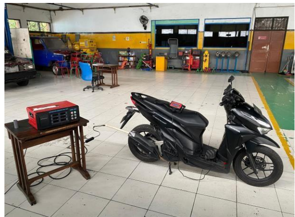
Gambar 3. Skema pemasangan Gas Analyzer
