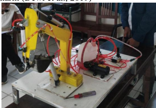
Gambar 2. Alat peraga hidrolik excavator
