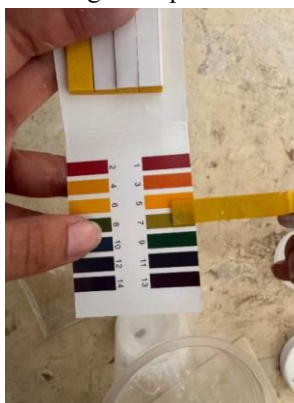
Gambar 1 Proses Uji Ph dengan kertas Ph (Sumber: Peneliti, 2026)
