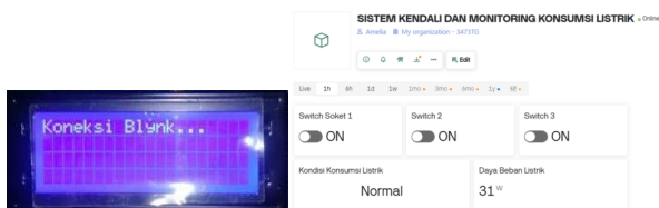
Gambar 4 Tampilan Hasil Pengujian Koneksi Cloud Blynk
