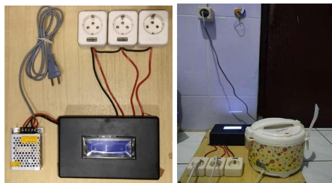
Gambar 17 Implementasi Pengujian Perangkat dengan Beban Rice Cooker dan Setrika
