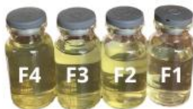
Gambar 1. Koloid nanoherbal ekstrak etanol daun sambung nyawa dengan berbagai variasi konsentras \text{CaCl}_2 (F1: 0,005% ; F2 : 0,01% ; F3 : 0,02% ; F4 : 0,03%)
