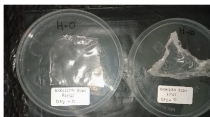
Gambar 1(f). Film plastik terbentuk sempurna setelah 48 jam, kiri (bioplastik asetat), kanan (bioplastik sitrat).
