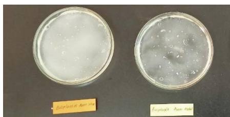
Gambar 1(e). Larutan pati yang telah mengental dicetak di dalam wadah.
