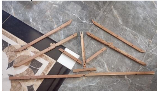
Gambar 3.6 Media Alat Peraga Kuda-kuda Kayu Sebelum Dirakit
