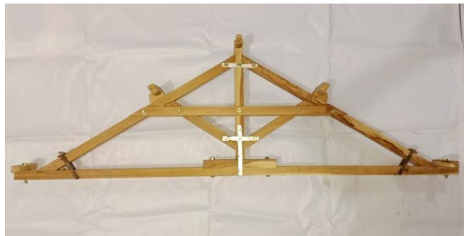
Gambar 3.6 Media Alat Peraga Kuda-kuda Kayu Setelah Dirakit
