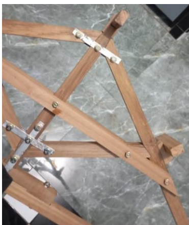
Gambar 3.8 Media Alat Peraga Kuda-kuda Kayu Sesudah Revisi
