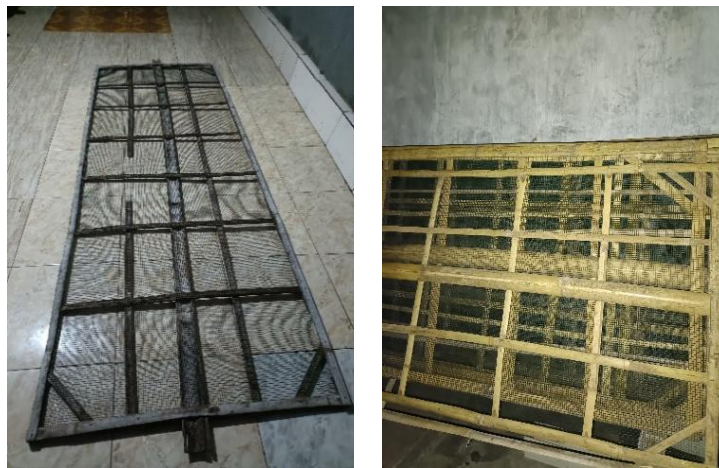
Gambar 3. Gambaran Rigen (buatan sendiri) alat penejemur slondok (Sumber: Dokumentasi Peneliti, 2025)
