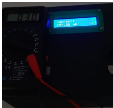
Gambar 4. Hasil Perbandingan Pengukuran Arus pada Multimeter dan Alat Ukur Berbasis Arduino
