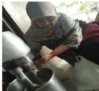
Gambar 3. Uji coba hasil rancangan alat pencampur ( mixer ) adonan donat kentang
