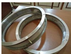
Gambar 6. Saringan bagian luar 40 mesh dan bagian dalam 100 mesh
