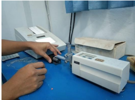
Gambar 3. Proses pengujian kekasaran
