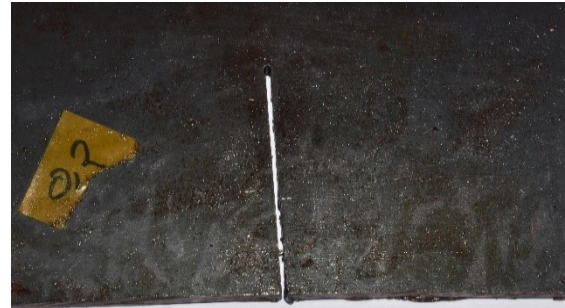
Gambar 5. Lebar Kerf dengan Ketinggian Torch 0.2 mm
