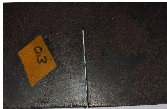
Gambar 6. Lebar Kerf dengan Ketinggian Torch 0.3 mm
