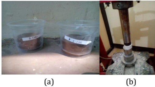
Gambar 1. (a) pengujian porositas dengan waktu perendaman 10 jam. (b) pengujian kuat tekan dengan alat press hidrolik
