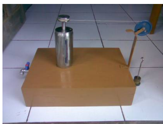
Gambar 4. Foto viscosimeter yang telah dikembangkan
