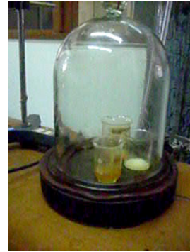
Gambar 2. Gel gallium citrate amine dalam desiccator vacuum
