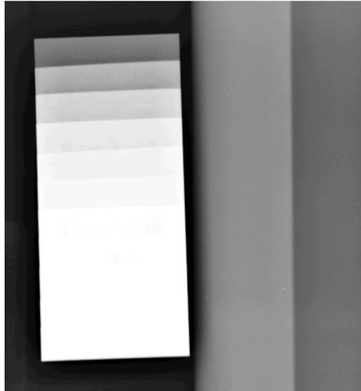
**Gambar 5.** Radiograf stepwedge menggunakan system CR
