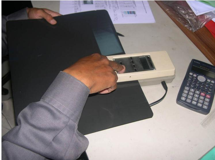
**Gambar 3.** Pengambilan data film radiograf *stepwedge* menggunakan densitometer
