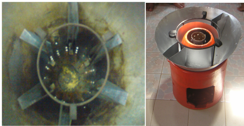
Gambar 4. Sirip saluran masuk udara; (a) tungku sekam dengan dua sirip dan (b) tungku sekam dengan enam sirip
