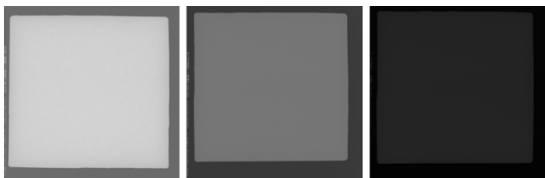
Gambar 5. Citra digital phantom tembaga sistem CR (A) 50 kV; 1,6 mAs; (B) 70 kV; 4 mAs dan (C) 81 kV; 32 mAs
