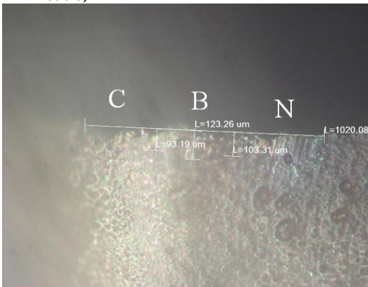
Gambar 5. Hasil pengukuran pahat ke-4 Gambar 5. menunjukkan keausan setelah dilakukan proses pemesinan CNC turning. Berdasarkan hasil pengukuran pahat ke-4 dari sisi samping pahat carbide menggunakan mikroskop infinity, terdapat keausan tepi ( VBB ) rata-rata dari dua titik adalah 0,098 mm, ( VBB max ) adalah 0,123 mm.
