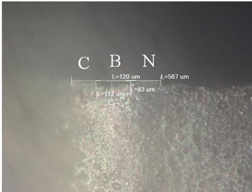
Gambar 4. Hasil pengukuran pahat ke-3 Gambar 4. menunjukkan keausan setelah dilakukan proses pemesinan CNC turning. Berdasarkan hasil pengukuran pahat ke-3 dari sisi samping pahat carbide menggunakan mikroskop infinity, terdapat keausan tepi ( VBB ) rata-rata dari dua titik adalah 0,0975 mm, ( VBB max ) adalah 0,120 mm.
