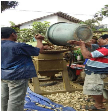
**Gambar 5.** *penggilingan janggel jagung dengan hammer mill*
