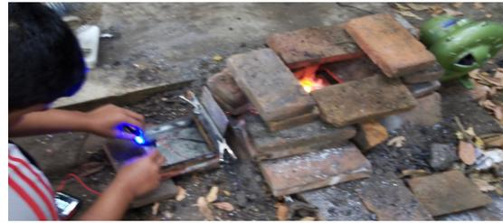
**Gambar 6.** Pemasangan modul TEG secara langsung pada tungku
