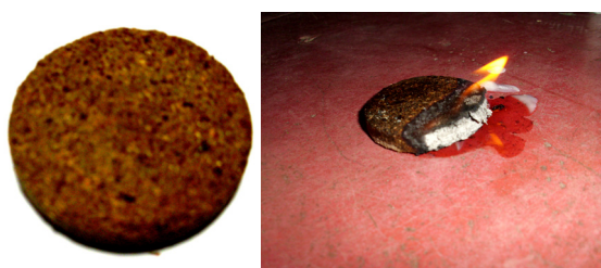
Gambar 6. (kiri) Hasil briket setelah pengembangan alat pemotong dan penghalus limbah kulit kolang-kaling serta alat pres, (kanan) briket dibakar dengan nyala api warna merah kekuningan dan asap tidak menimbulkan rasa gatal ketika mengenai kulit.
