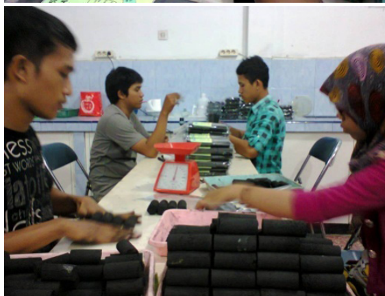
Gambar 4. Tahapan pengemasan briket limbah jagung.
