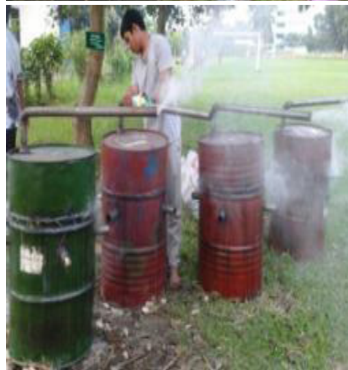
Gambar 1. Tong pirolisis dan praktek pengarangan limbah jagung
