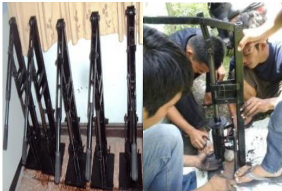
Gambar 2. (kiri) Alat pencetak briket, (kanan) praktek pencetakan briket
