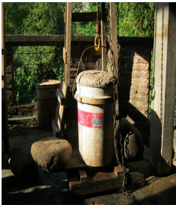
**Gambar 1. Alat Pengepres Tahu yang Semula Digunakan**
