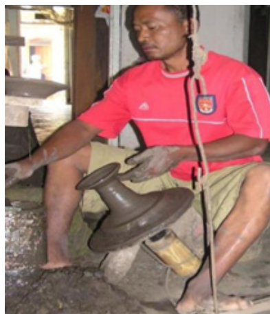
Gambar 1. Jono, Ketua Paguyuban Gerabah Pagelaran Utara sedang membentuk produk peralatan dapur tradisional dengan meja putar miring (dokumen Ponimin, 2019)
