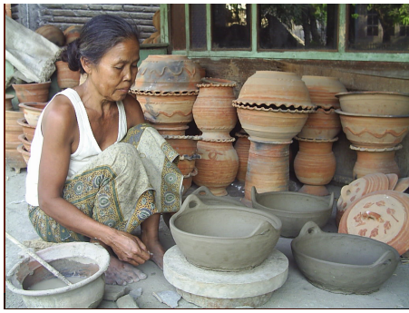
Gambar 2. Perajin gerabah tradisional Pagelaran Malang sedang membentuk gerabah dengan teknik putar lambat, berbahan tanah liat lokal dilanjutkan dengan teknik tatap pelandas (dokumen Ponimin, 2018)
