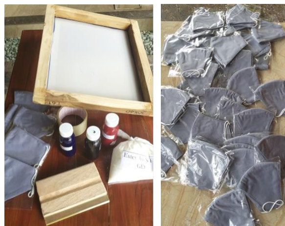
Gambar 2. Peralatan dan bahan latihan sablon pada masker kain
