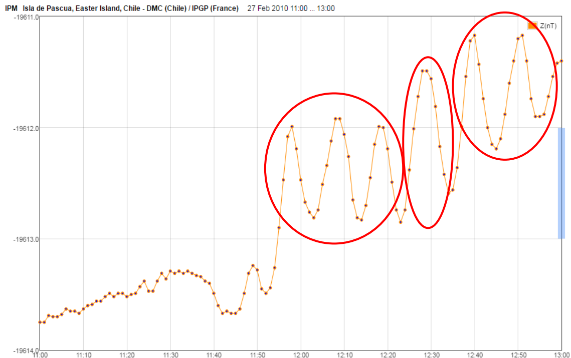
Gambar 2. Magnetogram BCMT untuk tsunami Chili 2010 yang teramati oleh stasiun IPM (3500 km dari episenter) sesudah merambat selama 5 jam dari episenter menuju stasiun IPM.
