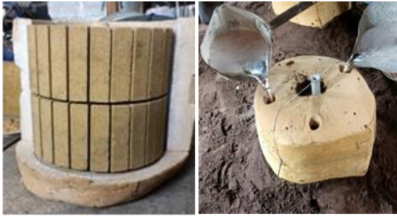
Gambar 3. (A) penggabungan inti dengan cetakan pengecoran (B) pengecoran
