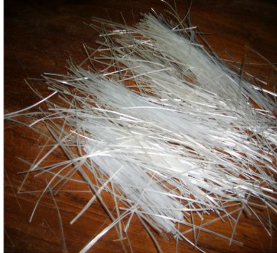
Gambar 1. Bentuk Fisik Serat *Roving*
