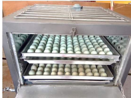
Gambar 3. Telur asin tertata rapi pada rak oven pemanggang kapasitas 450 butir
