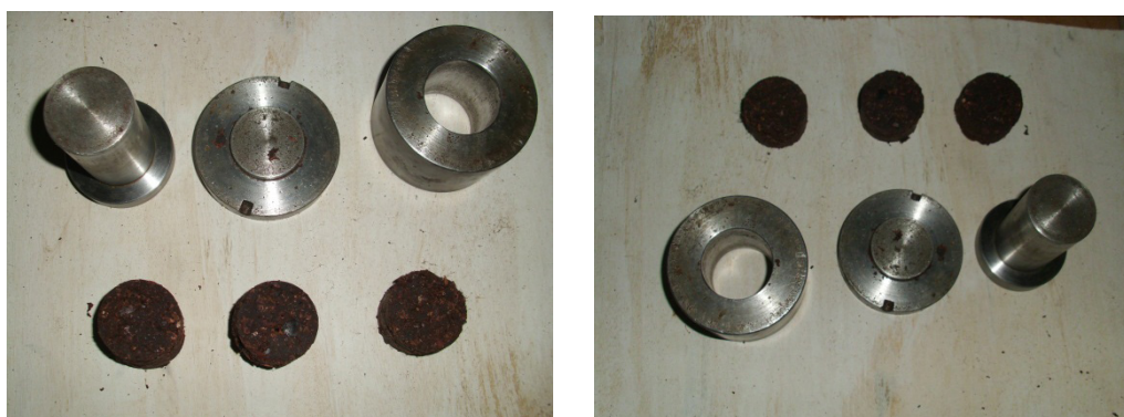
Gambar 4. Hasil cetakan briket yang berbentuk silinder dengan tebal 1,5 cm dan diameter 5 cm
