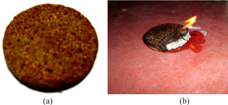
Gambar 6. (a) Hasil briket setelah pengembangan alat pemotong dan penghalus limbah kulit kolang-kaling serta alat pres, (b) briket dibakar dengan nyala api warna merah kekuningan dan asap tidak menimbulkan rasa gatal ketika mengenai kulit.
