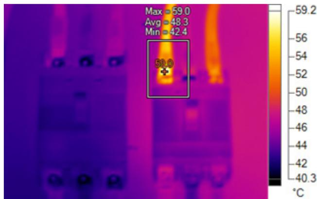
**Gambar 15. Thermogram MCCB Panel Trafo Dekanat FIP**
