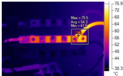
**Gambar 13. Hasil Analisis Suhu pada Panel Teknik 1 memakai SmartView**
