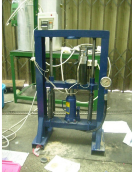
Gambar 1. Alat pembriketan dan cetakan briket
