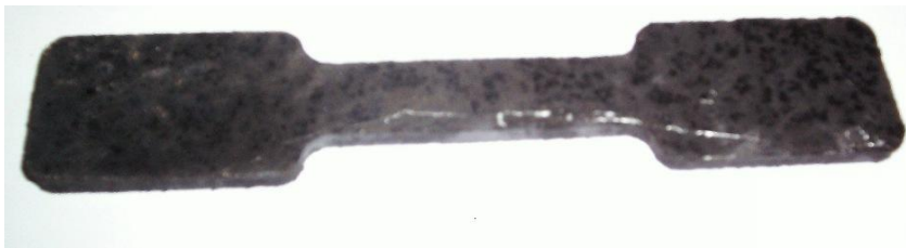
Gambar 3. Sampel untuk pengujian kekerasan dan kekuatan tarik
