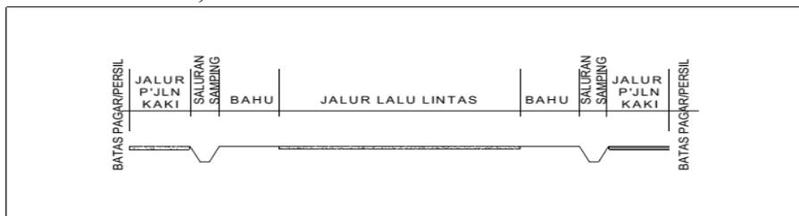
**Gambar 10.** Tipikal Penampang Melintang Jalan Perkotaan 2-Lajur-2arah. Sumber : RSNI T- 14 – 2004, Geometri Jalan Perkotaan
