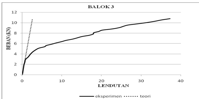
Gambar 12. Lendutan eksperimen Benda Uji 3.
