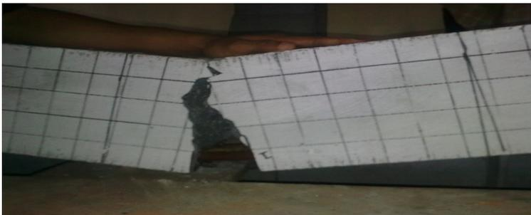
**Gambar 14. Keruntuhan pada Benda Uji 1**
