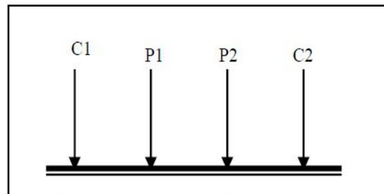
Gambar 3. Bentuk susunan elektroda pada survey geolistrik tahanan jenis
