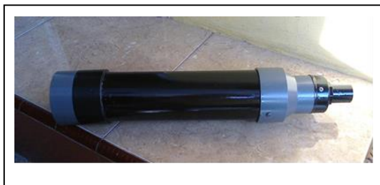
Gambar 3. Realisasi teropong bintang sederhana dari bahan pipa peralon menggunakan dua buah lensa cembung, yaitu lensa obyektif dan lensa okuler (untuk skala latihan: F_{ob} = 33,70\text{cm} dan F_{ok} = 19,07\text{cm} ).
