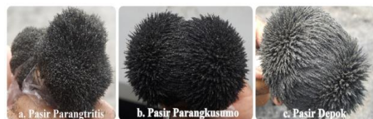
Gambar 2. Garis medan magnet yang terlihat pada pasir uji yang diekstrak menggunakan magnet permanen.
